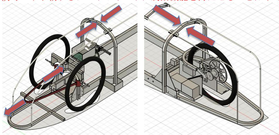
ゲージ接触箇所の例：ステアリングポストやロールバーなど。車検時のみテストポイントを車載する場合の例として赤いロープを示す
